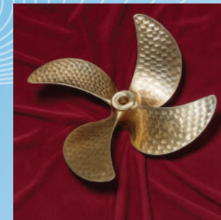
طراحی و ساخت پروانه‌ی چهار پره مدل شمشیری (High Skew) برای شناور لنج
