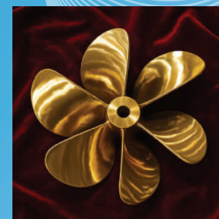
طراحی و ساخت پروانه‌ی شش پره برای شناور خدماتی (عدم وجود ارتفاع کافی برای پروانه)
